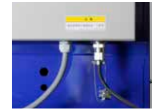
พอร์ตตัวต่อสาย สวิทช์ควบคุมแบบห้อยเชื่อมต่อกันด้วยตัวต่อ สายไฟและสายควบคุมสามารถจัดเก็บไว้ใต้แผงควบคุมได้
